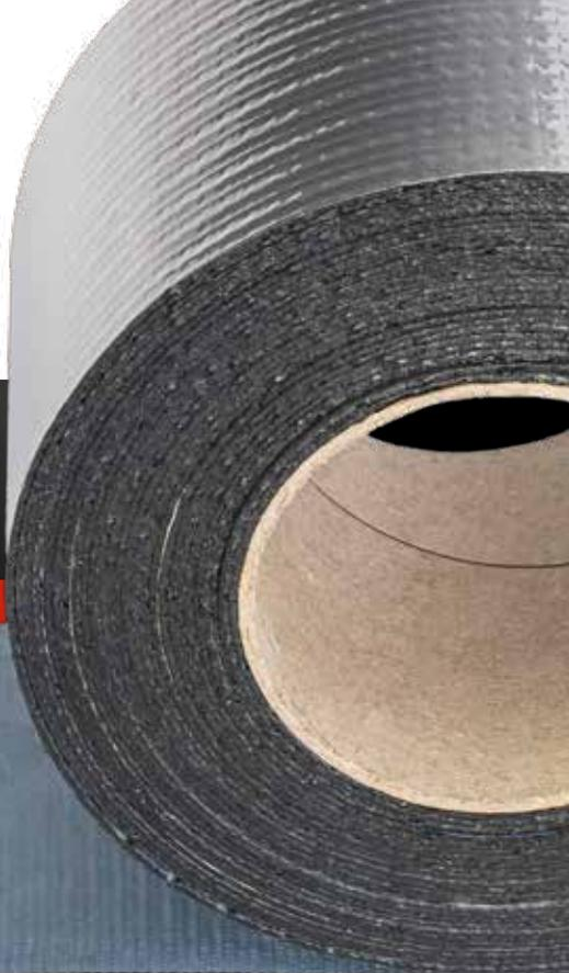
**BIT-TAPE** sono dei nastri bituminosi autoadesivi impermeabili, costituiti da compound in bitume-SBS autoadesivo e protetti da lamina metallica in alluminio autoprotetto da film di poliestere.
